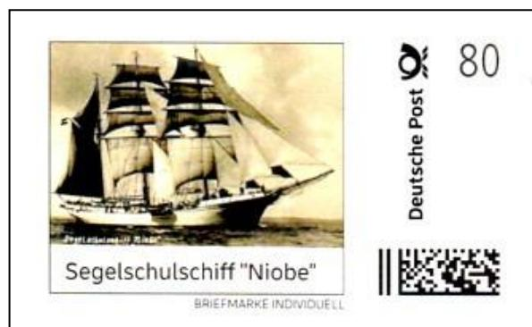
Länge \* Breite \* Tiefgang 89,3 \* 12 \* 5 Meter, 23 Segel, insgesamt 1952 qm.
